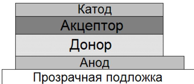
Рис. 4. Схема двухслойного органического фотоэлемента. Активный слой содержит два параллельных слоя донорного и акцепторного материала.
