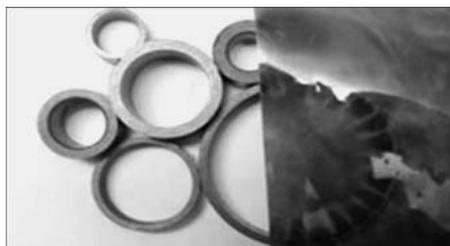
Редкоземельные монокристаллические магнитные системы с неоднородным намагничиванием полюсов
