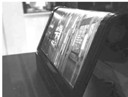
Рис. 2. Скручиваемый 18-дюймовый (46 см) OLED-дисплей на пластиковой подложке от LG. Фотография предоставлена IDTechEx
